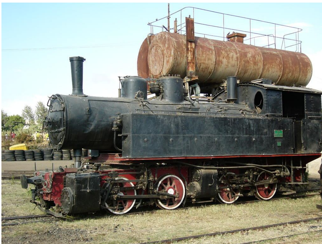
Asmara: l’Ansaldo Mallet R.440-008, ultimo esemplare in servizio del gruppo 440
