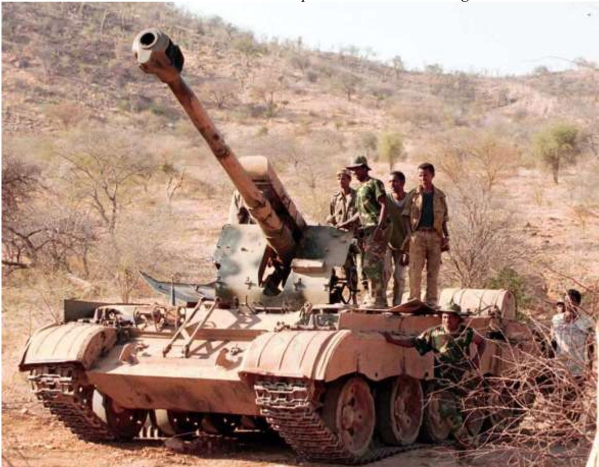
*Un semovente realizzato montando sullo scafo di un T-54/55 un obice.cannone M1963 D30 da 122mm*
